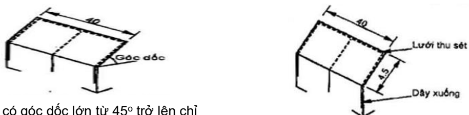
Hình 11 - Thu sét cho mái có diện tích lớn và nhiều đỉnh nóc
