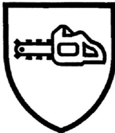
Hình 2 - Biểu tượng chỉ sự bảo vệ chống cắt bởi cưa xích (ký hiệu 2416 của ISO 7000:2004)
