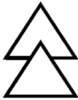
Hình 5a – Ký hiệu IEC 60417-5216 – Thích hợp để làm việc có điện; tam giác kép
