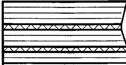
Hình 3 - Cạnh cắt hình thành bằng cách cắt các cạnh của các tấm kính thành phần chưa gia công
